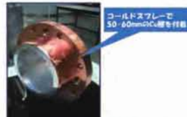
Al管上へ高圧コールドスプレー法を用いた、 50\text{-}50\mu\text{m} の粒子から、 50\text{-}60\mu\text{m} の厚い銅成膜に成功。穴開け、ねじ切り等の後続加工も可能
