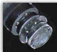
超精密加工により作製した WGM 微小光共振器 (直径 400um)
