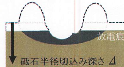
図 3 単発放電痕形状と砥石半径切込み深さ \Delta の関係
